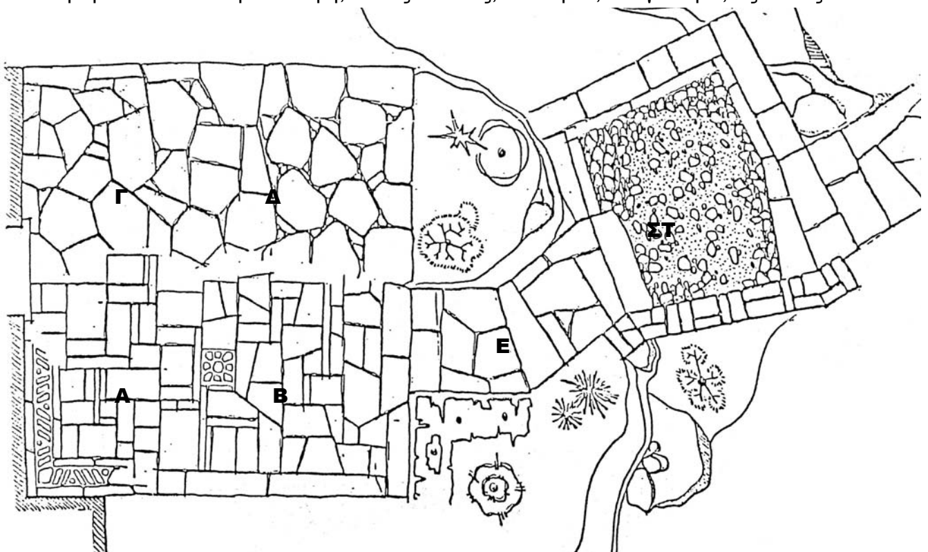
πιν. 21: Παραδείγματα διαφόρων τύπων πλακόστρωσης. Στον τύπο Α οι πλάκες είναι παραλληλόγραμμες, ενώ στον τύπο Β συμμετέχουν και πλάκες σχήματος τραπεζίου. Οι πλάκες του τύπου Γ είναι πολυγωνικές, με ακανόνιστα σχήματα. Οι πλάκες του τύπου Δ είναι επίσης πολυγωνικές, αλλά με στρογγυλεμένες γωνίες, που συμπληρώνονται με μικρότερες ή με βότσαλα. Ο τύπος Ε εμφανίζεται σε καλντερίμια, που καταλήγουν συχνά σε πλατώματα με χώμα και βότσαλα (τύπος ΣΤ).
