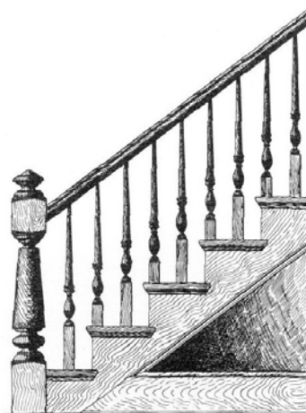
πιν. 76,77: Ενδεικτικά παραδείγματα λεπτομερειών κουπαστής σκάλας
