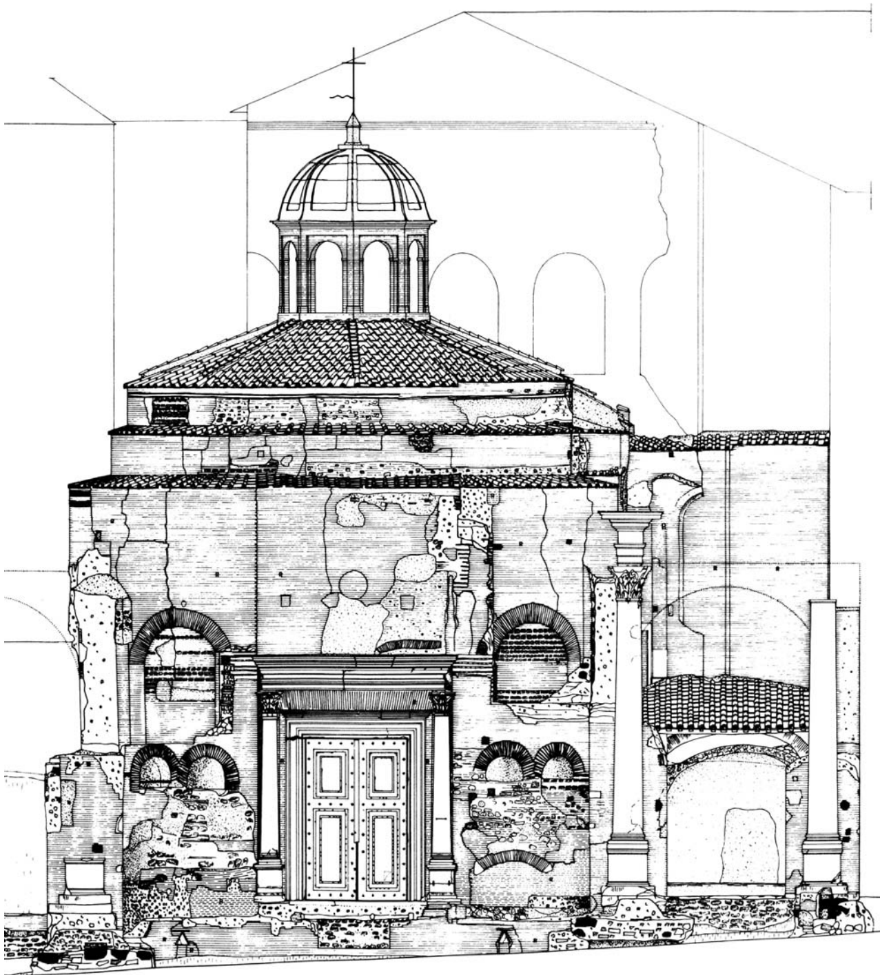
πιν. 51: Ενδεικτικό παράδειγμα όψης μνημείου, όπου έχουν αποτυπωθεί και σχεδιαστεί με λεπτομέρεια όλα τα δομικά υλικά και τα υλικά επίστρωσης, με τις φθορές και ρηγματώσεις τους
